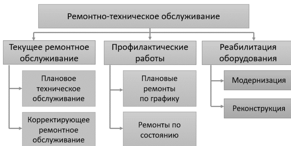
Рисунок 1.7 – Виды ТОиР систем АППЗ
