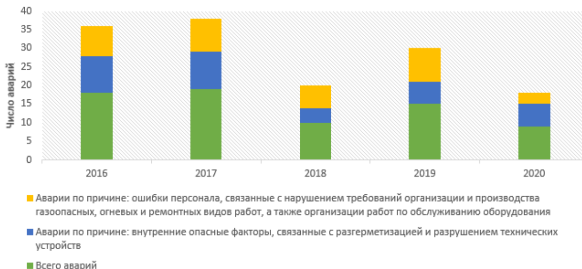
Рисунок 1.8 – Статистика причин аварий на объектах нефтехимических и нефтеперерабатывающих производств и объектах нефтепродуктообеспечения за 2016–2020 гг.
