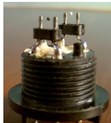
Рисунок 1.5 – Устройство датчика термохимического газосигнализатора: 1 – газообменный фильтр из пористой металлокерамики; 2 – чувствительный элемент; 3 – компенсирующий элемент; 4 – реакционная камера; 5 – изоляционная колодка
