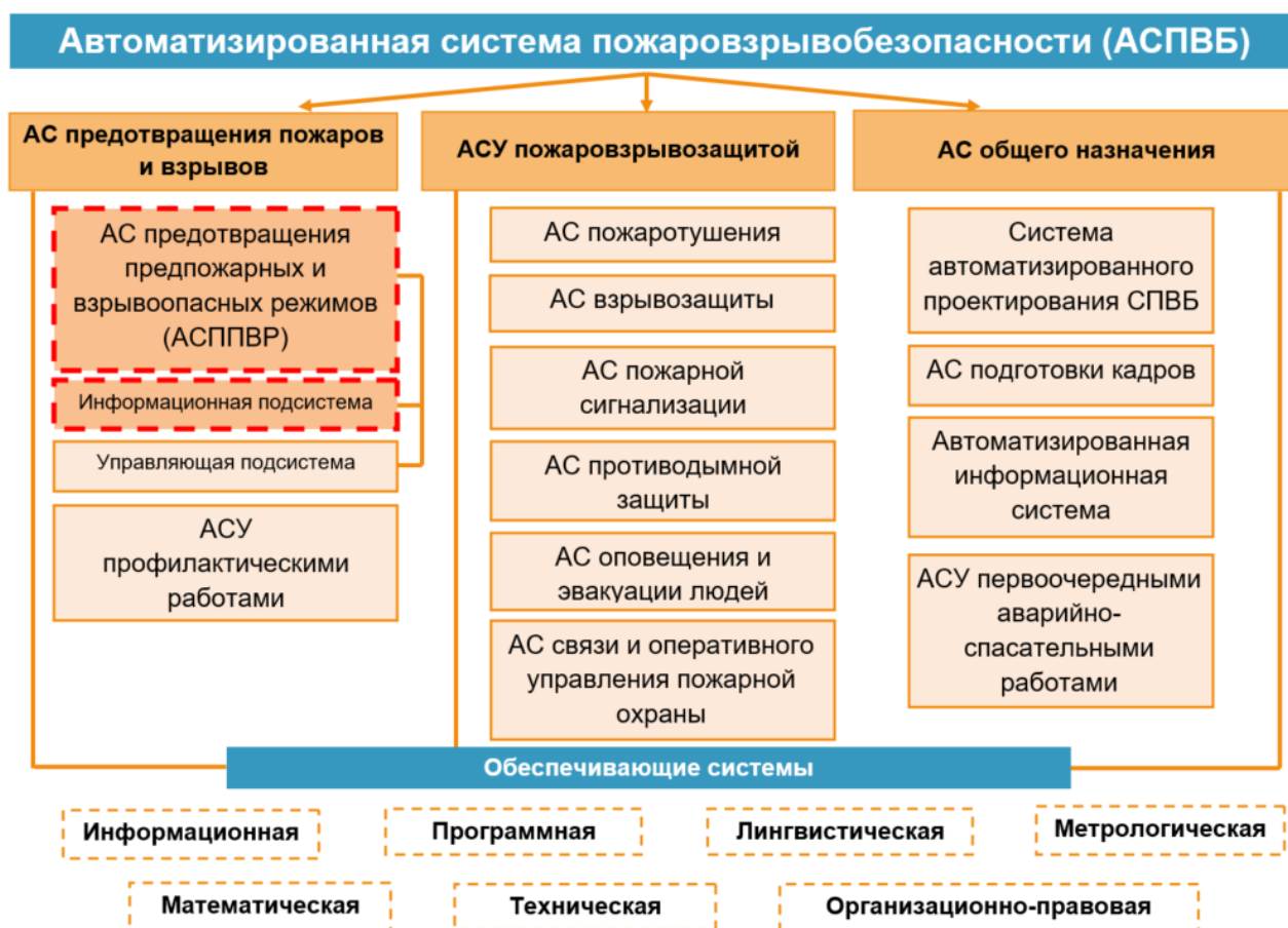
Рисунок 1.4 – Схема связей между подсистемами автоматизированной системы пожаровзрывобезопасности
